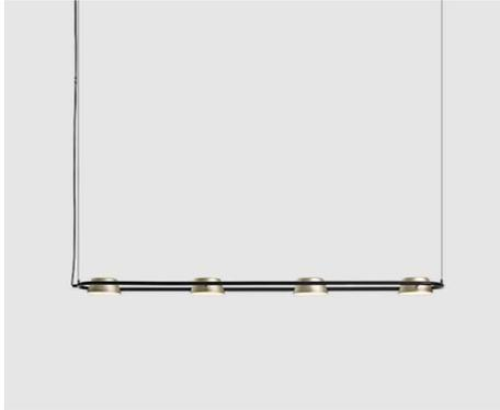
Luminario decorativo para suspender modelo OLO PL4. Fabricado con estructura de acero y pantalla de aluminio con acabado en poliéster de aplicación electrostática color negro brillante / champagne / cocoa. Pantalla de PP, con sistema giratorio 180°. Suspensión de acero 3.5 m. Incluye sistema LED CREE atenuable.
