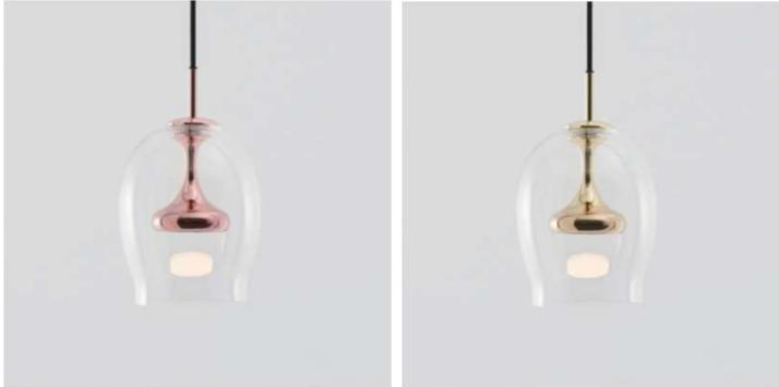
Luminario decorativo para suspender modelo MOAI M. Estructura fabricada en acero con acabado cromado color cobre / latón y pantalla de cristal claro. Cable para suspender forrado en tela de 2.0 m. Incluye sistema de LED CREE 8.5W, 400 lm, 3000K, CRI 90, atenuable.
