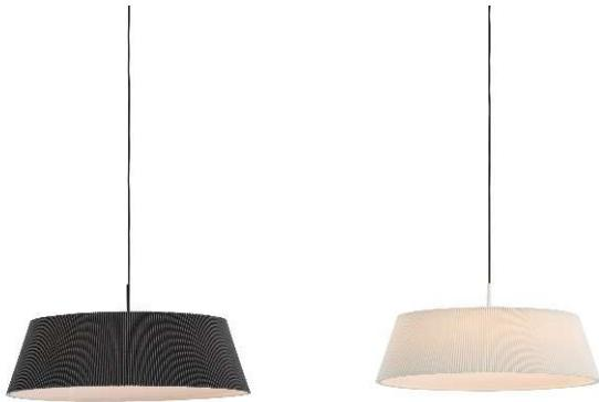
Luminario decorativo para suspender modelo **HALO P**. Cuerpo fabricado en inyección de aluminio y estructura de acero con acabado en poliéster de aplicación electrostática. Pantalla de tela de algodón plisada con estructura de poliestireno blanco termoformado. Sistema LED atenuable TRIAC integrado.
