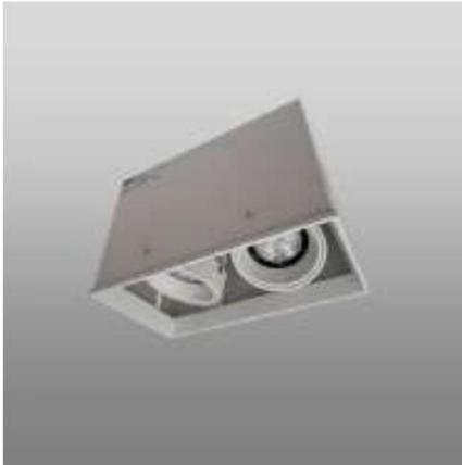
Downlight para empotrar en plafón modelo **SEDE TRIMLESS MR16**. Fabricado en lámina de acero rolada en frío con arillos dirigibles con movimiento cardánico fabricados en aluminio con acabado en poliéster de aplicación electrostática color blanco mate. Para 2 lámparas MR16 GU5.3.
